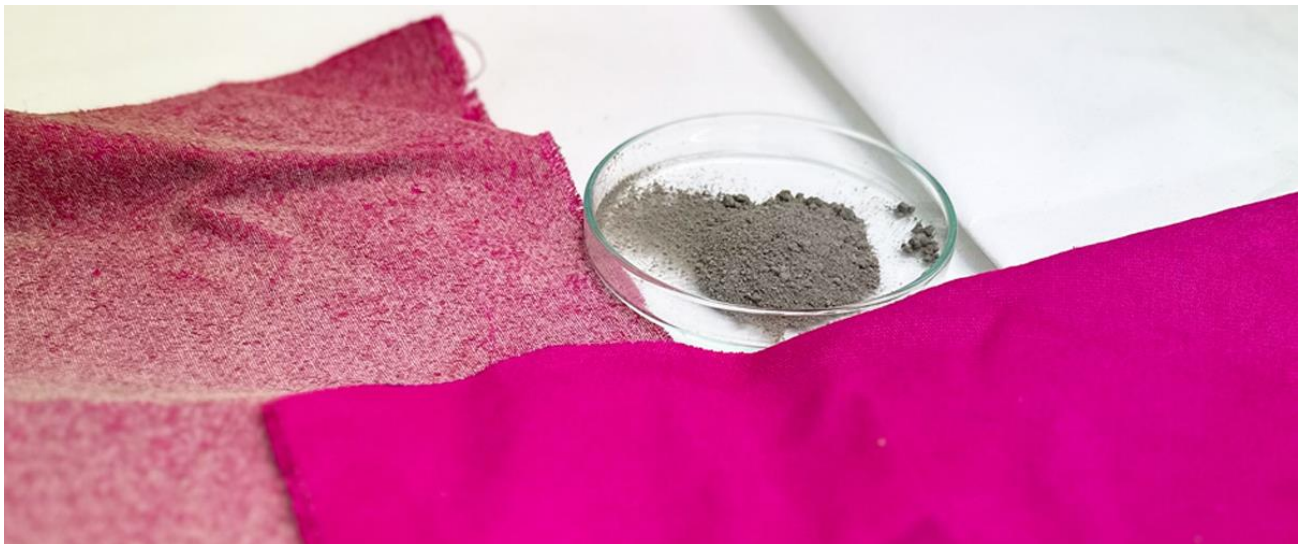
Eine Baumwollprobe, die mit Nanodiamanten behandelt wurde, neben einer unbehandelten Baumwollprobe.
