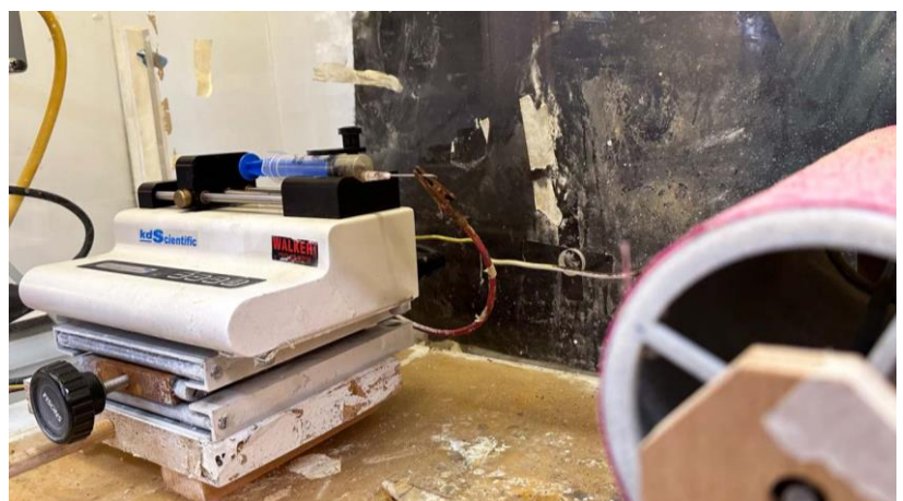
Die Elektrospinmaschine erzeugt ein Netz aus Nanofasern auf den Baumwollfasern, die dann ausgehärtet werden, um die beiden zu verbinden.
