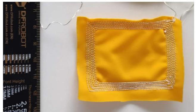
Die Antenne wird spulenförmig direkt auf den Stoff gestickt. (Bild: Valeria Galli / ETH Zürich)
