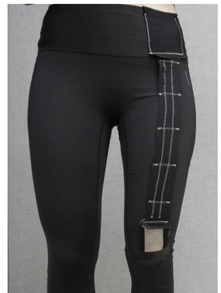
Der Textilsensor über dem Knie ist mit einer Antenne verbunden, die am Bund der Hose eingelassen ist. Zusammen bilden sie einen Schaltkreis, mit dem Bewegungen gemessen werden können.
