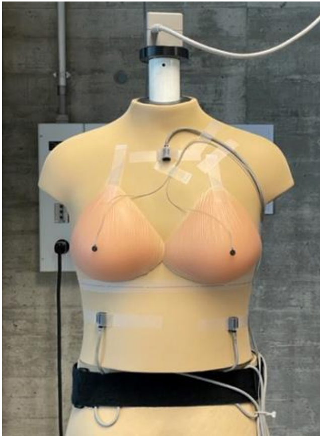
Das Messmannequin «Nici» wurde entwickelt, um die mechanischen Eigenschaften von BHs zu untersuchen. Bild: Empa
