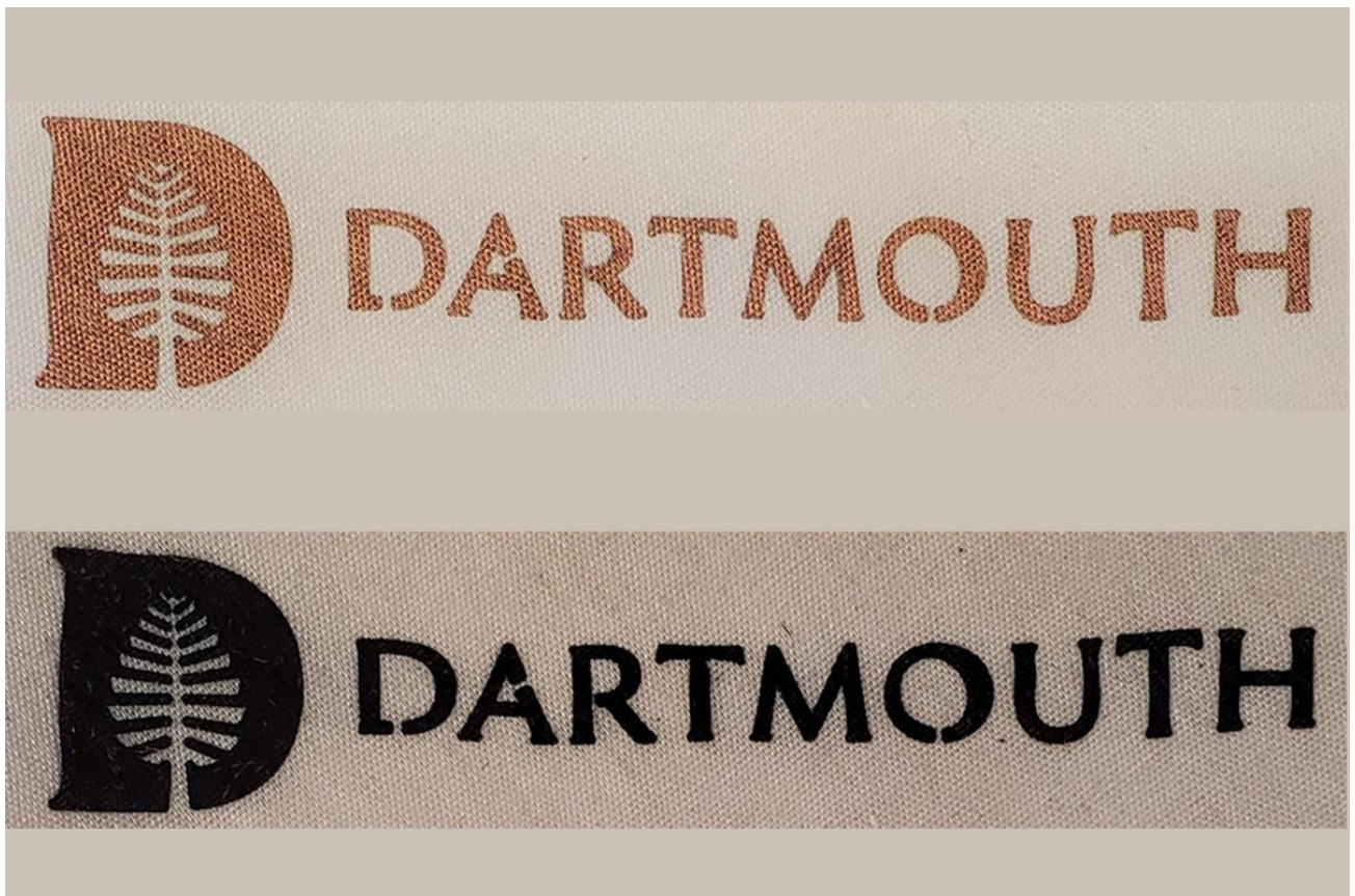
Auf Stoff aufgedrucktes Kupfer (oben) wird durch ein metallorganisches Gerüst (unten) ersetzt, das in der Lage ist, giftige Gase aufzuspüren und aufzufangen. Foto: Katherine Mirica
