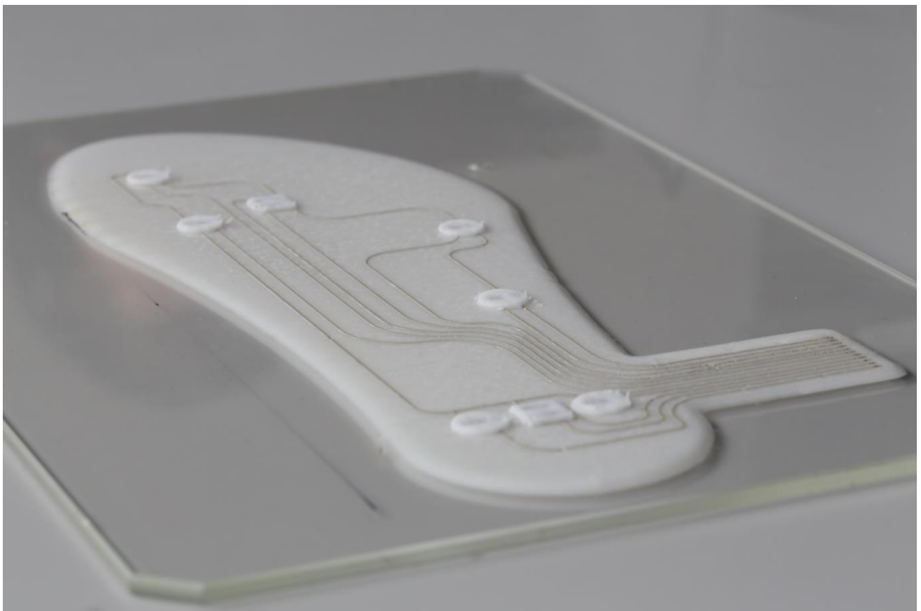
Die maßgeschneiderte Einlegesohle mit integrierten Drucksensoren kann den Fußsohlendruck direkt im Schuh bei verschiedenen Aktivitäten messen. Bild: Marco Binelli, ETH Zürich
