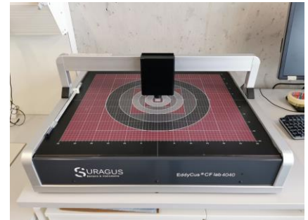
© Fraunhofer IGCV Messgerät zur zerstörungsfreien Prüfung der Materialien mittels Wirbelstrom- technologie
