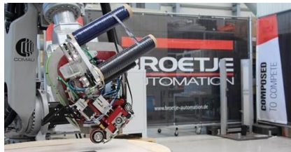
© BA Composites Anlage zur Weiterverarbeitung der vorimprägnierten rCF-Halbzeuge mittels Fibre-Placement-Technologie
