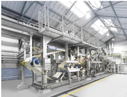
© Voith Anlage zur Herstellung von Nassvliesstoffen
