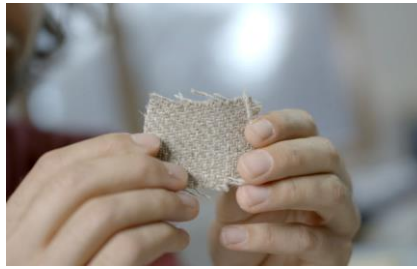
Gewebe aus Flachsfasern, das als Verstärkung in das Board eingebracht wird.
