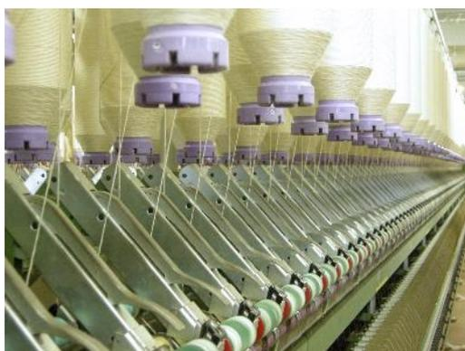
Ringspinnmaschine © Bühler AG
