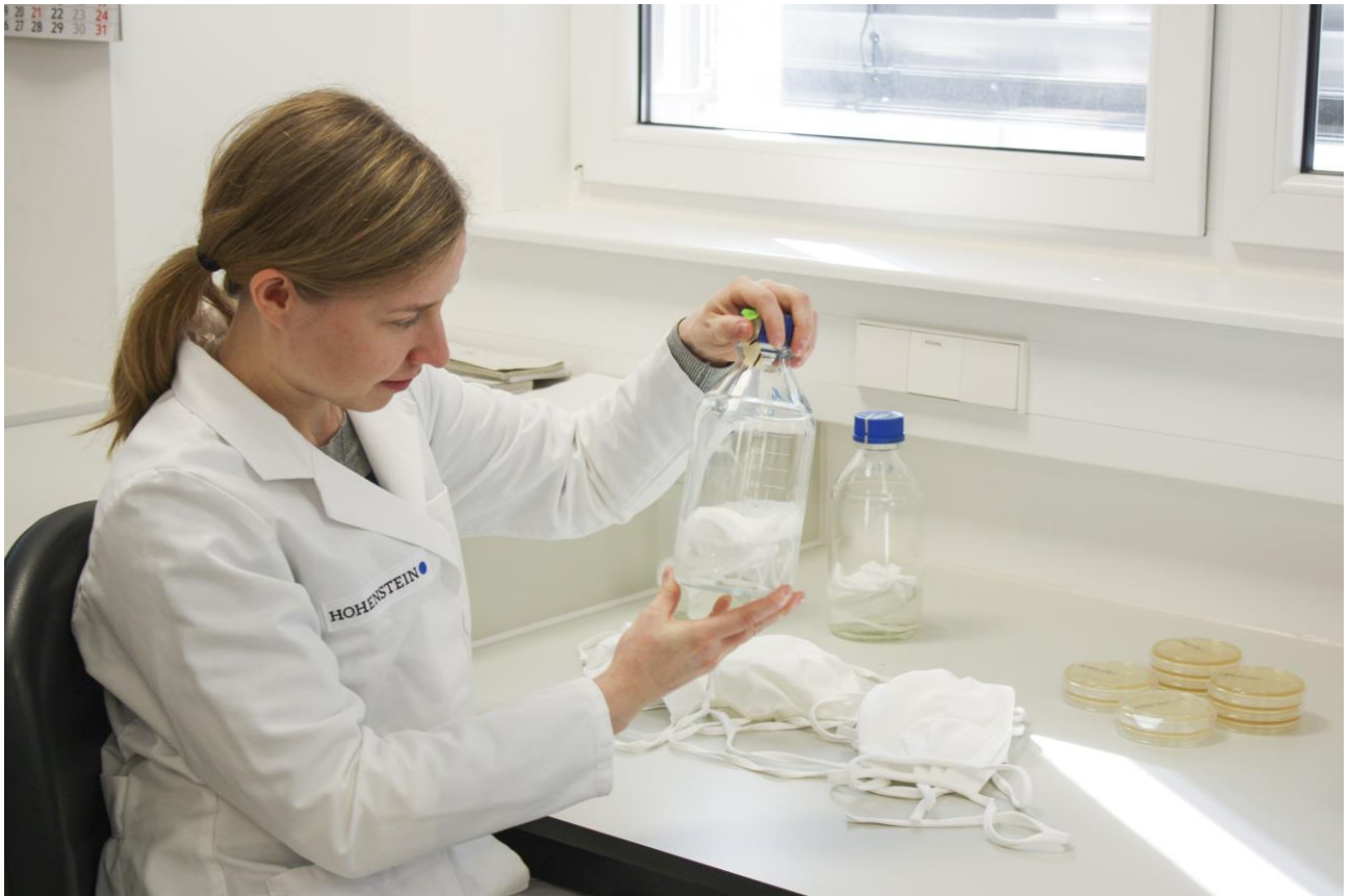
© Hohenstein Prüfung der Keimbelastung einer Maske am Institut Hohenstein
