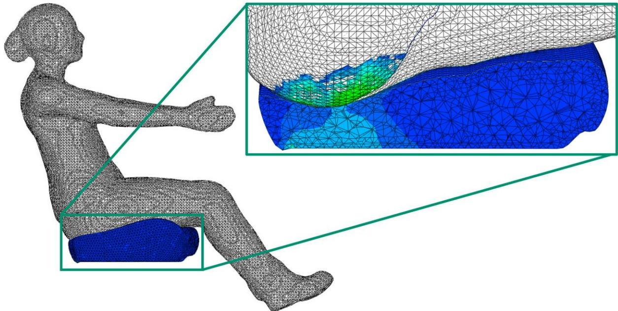
Mit einem digitalen Abbild einer Fahrerin wird das quasi-statische Einsitzen in den Fahrzeugsitz modelliert. ©Fraunhofer ITWM
