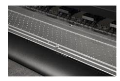
Der Mimaki Textildirektdrucker Tx300P-1800 MkII hat eine leicht austauschbare Auflagefläche, die zusätzlich den Druck auf Transferpapier ermöglicht.
