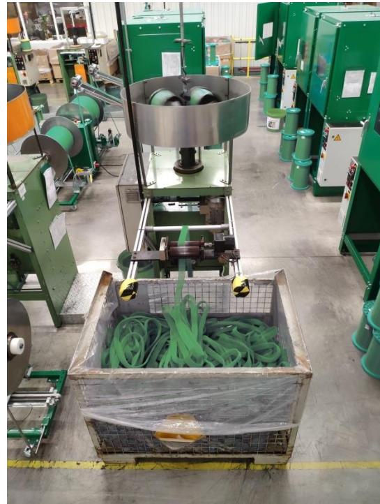
Sensorbasierte Nachrüstung einer Rundstrickmaschine der thoenes® Dichtungstechnik GmbH durch das Sächsische Textilforschungsinstitut e.V. (STFI)
