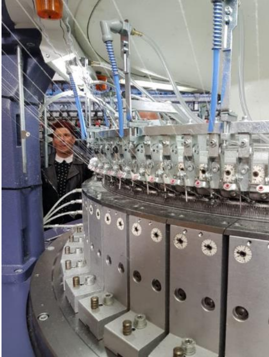
Rundstrickmaschine mit Spinn-Strick-Prozess corizon® (Foto: STFI)
