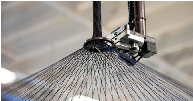
Flechtkopf zum Herstellen von Schlauchgeflechten.
