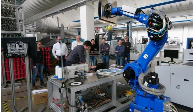
In der Labtour wird eine robotergestützte Bandeinfassung in Kombination mit einem Kamerasystem zur Arbeitssicherheit gezeigt. Foto: STFI
