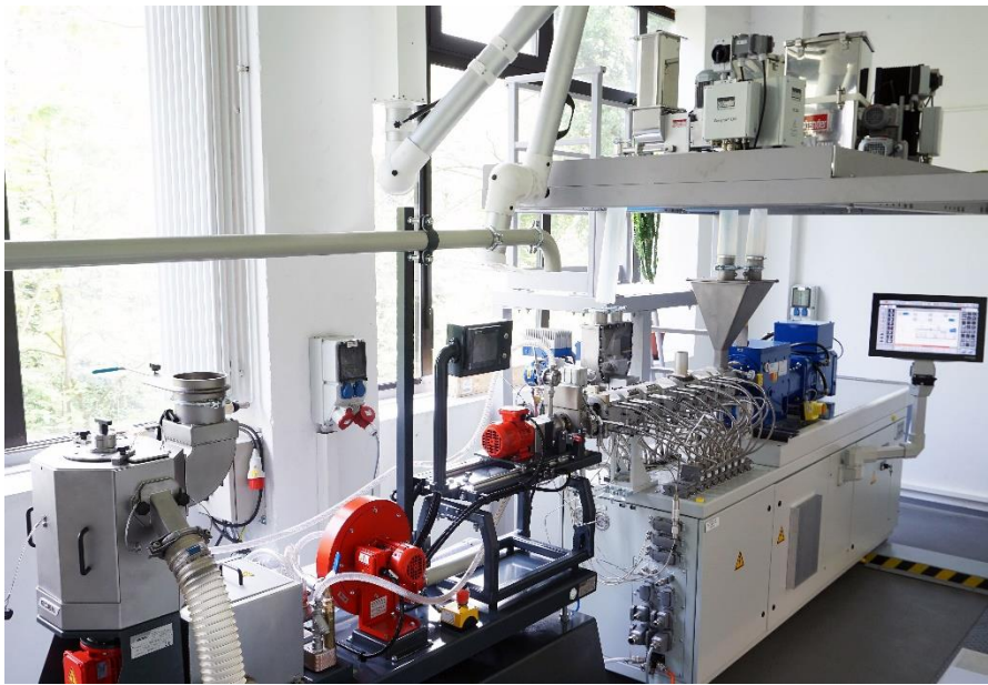
In solch einer Compoundieranlage lassen sich auch Biokunststoffe aufbereiten. Bildquelle: KUZ
